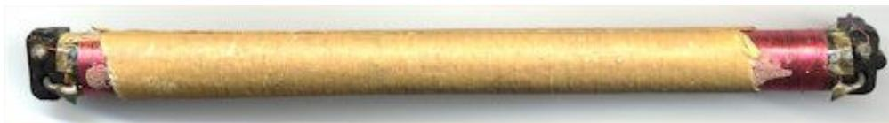
*Bild 10: Y-Verzögerungsleitung für das Luminanzsignal (~800ns)*
