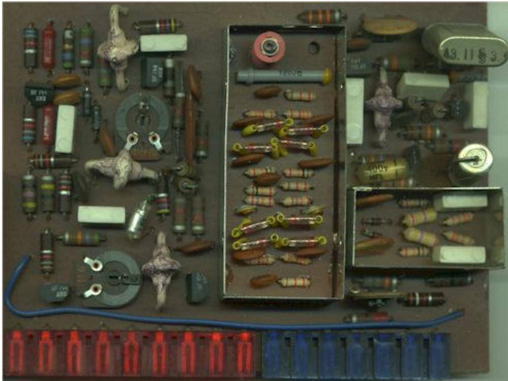
*Bild 2: PAL Decoder – diskret aufgebauter PAL Decoder – erkennbar rechts oben der 4,43 MHz Referenzoszillator, im großen Rahmen Teile der beiden Synchrondemodulatoren, im kleinen Rahmen der Burst Phasenvergleich,*
